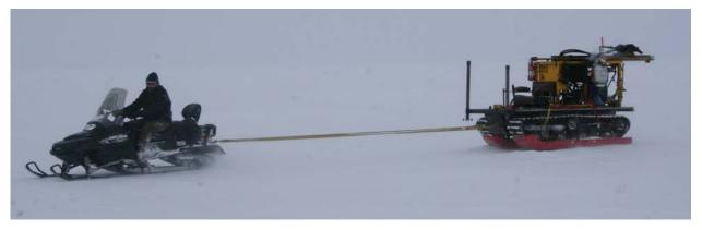
FIGURE 12 - DOT&PF'S B24 DRILL TRANSPORTED BY SNOWMACHINE
